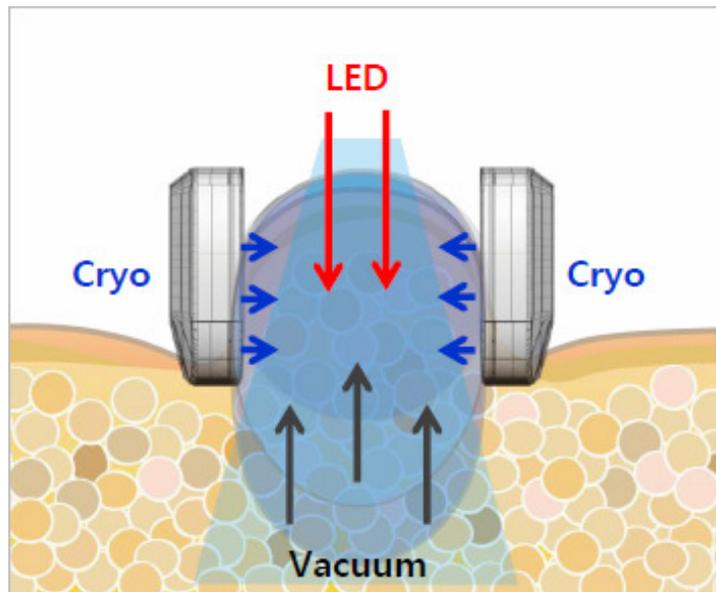
Bei diesem Applikator sind die metallischen Kälteplatten in das Hautkontaktmaterial eingearbeitet, was einen Direktkontakt der Metallplatten mit der Haut und somit eine Verbrennung der Epidermis (Freeze Burns durch beschädigte Kälteschutzvliese) verhindert.
